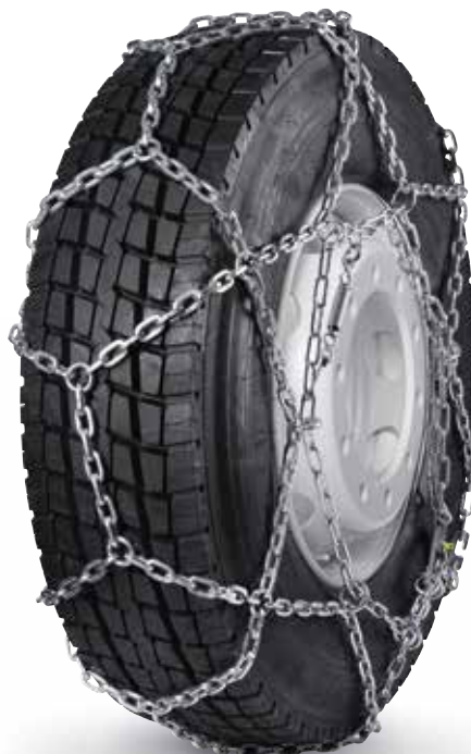
* CL: łańcuchy z drutu o średnicy 5,6 i 7 mm produkowane w Austrii, łańcuchy z drutu o średnicy 4,5 mm produkowane w Czechach
